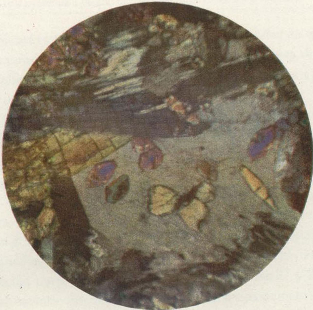
Fig. 27 (x. 80) Epidoto en una caliza dolomítica.
